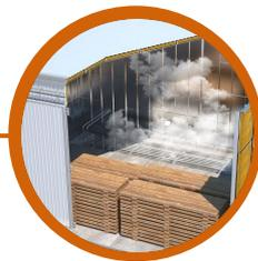
**Камерная сушка дерева** – пиломатериалы подвергаются воздействию высокой температуры в специальных камерах. Это позволяет удалить влагу из дерева, сохраняя его форму и структуру для более долговечного использования
